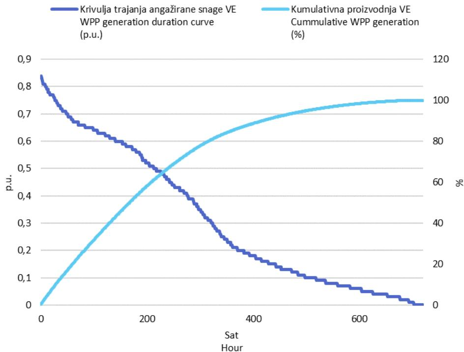
**Slika 3 Krivulja trajanja angažirane snage svih VE i kumulativna proizvodnja VE u travnju 2023. godine u jediničnim vrijednostima**
