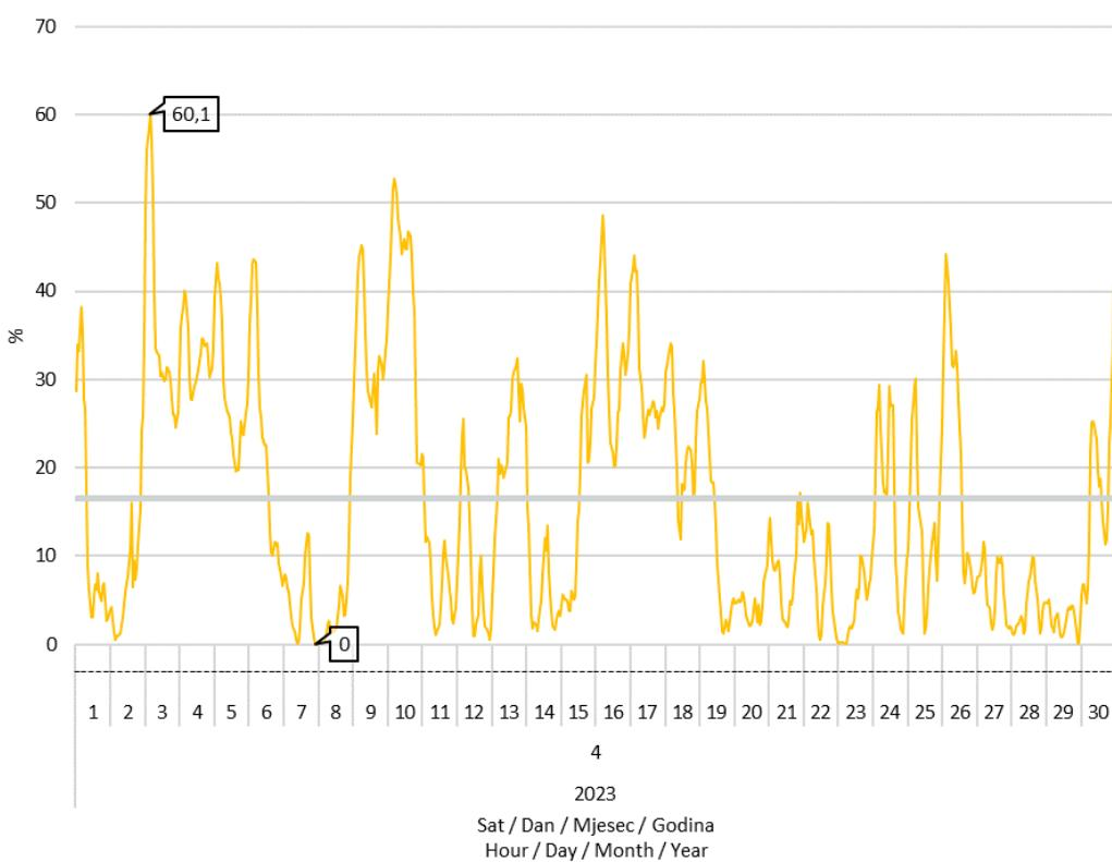
**Slika 8 Udio proizvodnje vjetroelektrana u pokrivanju satnog opterećenja elektroenergetskog sustava u travnju 2023. godine**
